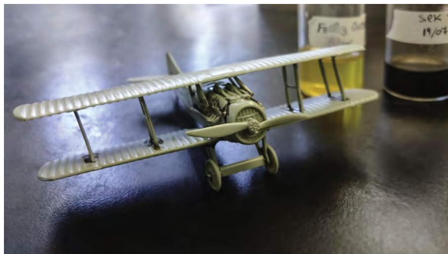
Model letala, sestavljen z lepilom na osnovi svile. Zasluge: Marco Lo Presti, Univerza Tufts
