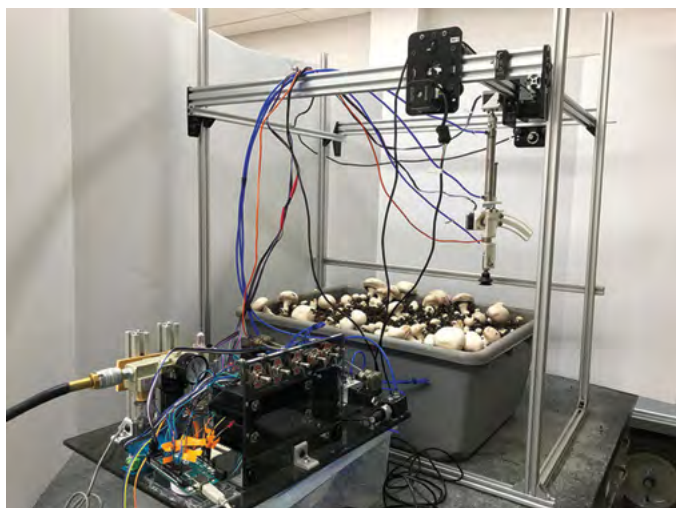
Slika3: Prototip je bil zasnovan za samodejno nabiranje in obrezovanje gob, ki rastejo v regalnem sistemu. Gobarska industrija se sooča s pomanjkanjem delovne sile in naraščajočimi stroški delovne sile, zato bi lahko mehansko ali robotsko obiranje te težave ublažilo. Zasluge: Penn State
