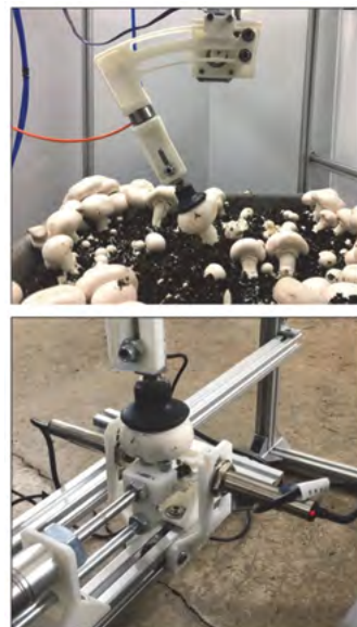
Slika2: Prototip, ki je zasnovan tako, da je integriran s sistemom strojnega vida, je pokazal, da je sposoben tako nabirati gobe s pnevmatskim sistemom (zgornja fotografija), kot jih tudi obrezati (spodnja fotografija).
