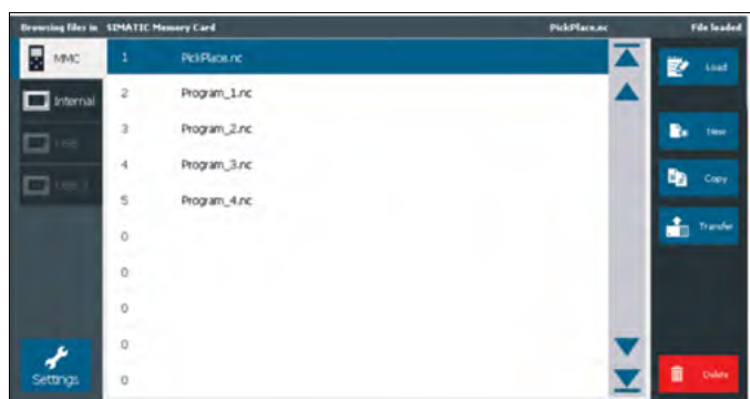
Slika 3: HMI Vmesnik za nalaganje G-kode iz USB ključka ali SD kartice na PLC
