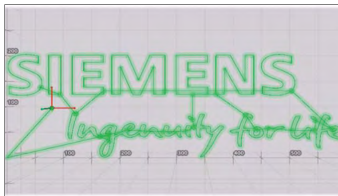
Slika 5: Primer G-kode, kjer izris je izveden s trace funkcijo znotraj tehnološkega objekta TO_Kinematics
