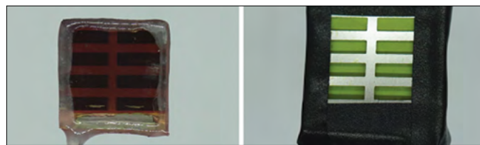
Več BiOI in BiOI-BiVO4 pikselov na napravi. Avtor: Dr. Virgil Andrei.
