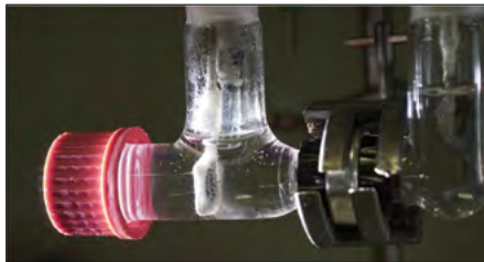
BiOI piksli pri osvetlitvi proizvajajo vodikove mehurčke. Avtor: Dr. Virgil Andrei.
