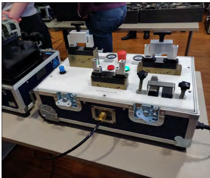
Adheso prijemalo je primerno za prijemanje delikatnih in lahkih predmetov
