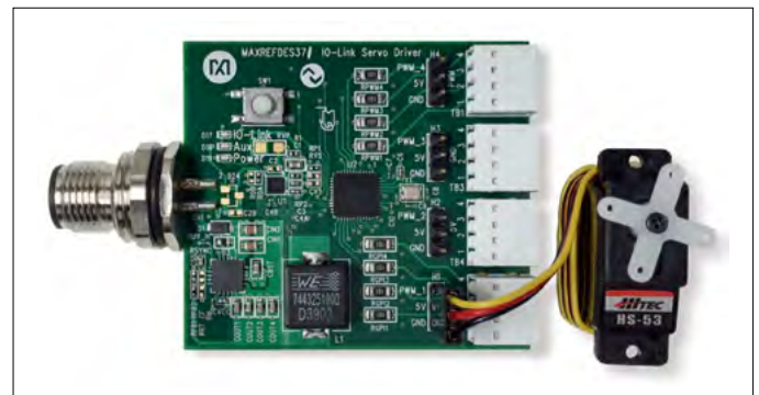
Slika 4:- MAXREFDES37# vključuje konektor M12 (levo) za priključitev z nadrejeno IO-Link napravo in servomotorjem (desno). (Vir slike: Analog Devices)
