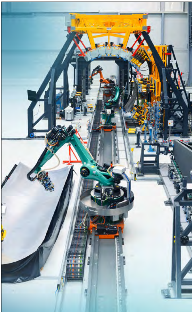
Montaža velike konstrukcije v merilu 1:1 v 4500 m 2 veliki raziskovalni dvorani z višino 15 m v Fraunhoferjevem inštitutu IFAM v Stadu v Nemčiji. (vir: https://www.ifam.fraunhofer.de/ )
