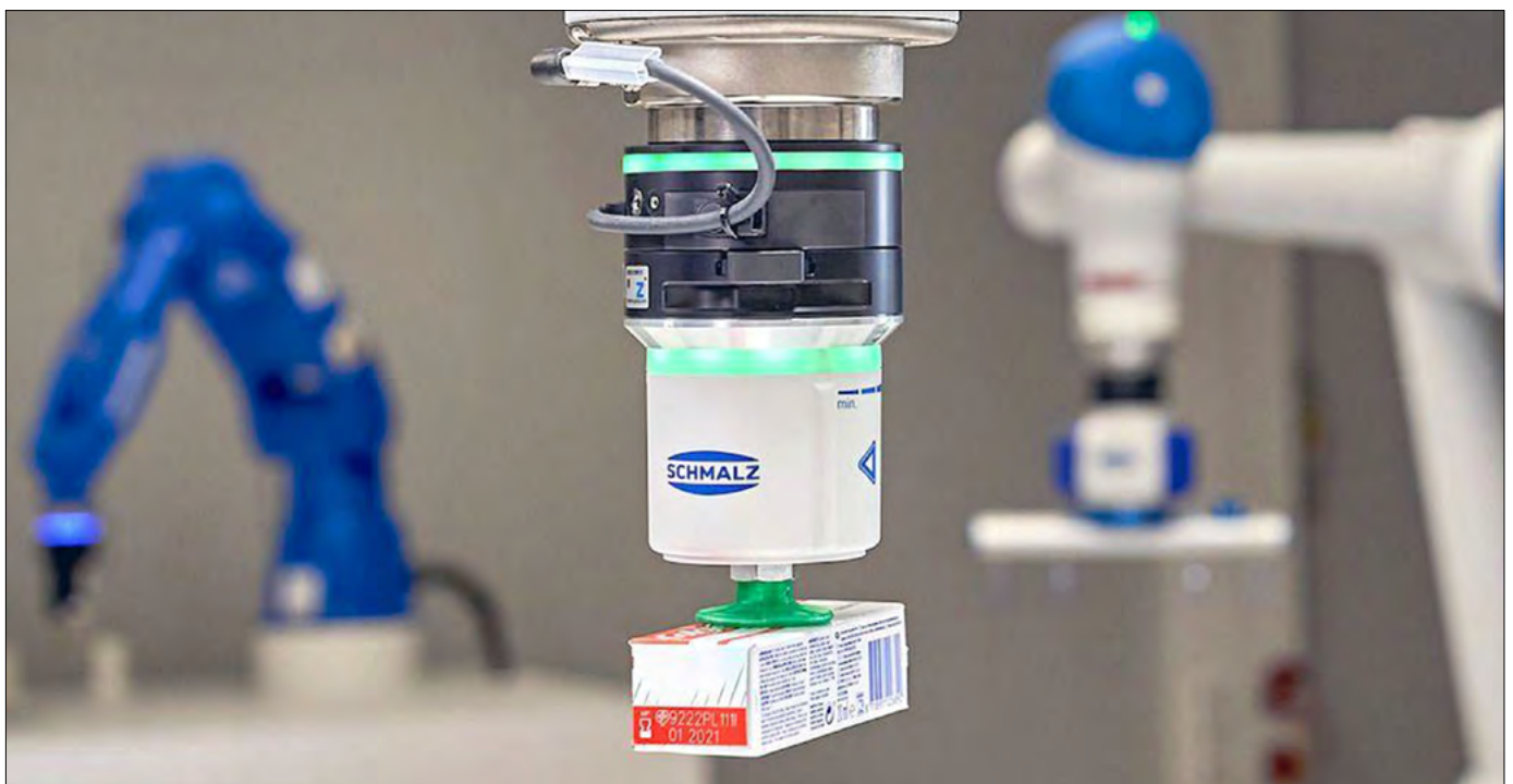
Nova cobot črpalka ECBPMi, zasnovana za manipulacijo manjših neporoznih delov – brez stisnjenega zraka. (Vir: Schmalz)
