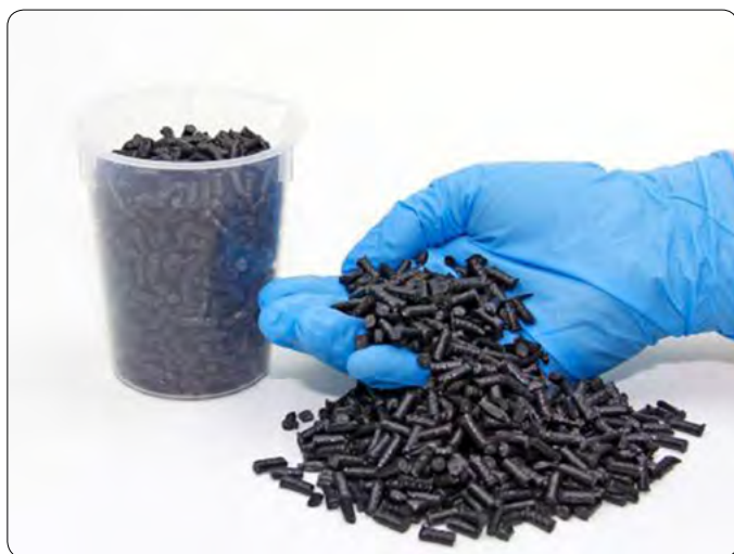
Slika 1: Parker Chomerics Premier linija je mešanica termoplastičnih polimernih PC/ABS zlitin in prevodnih polnil.
