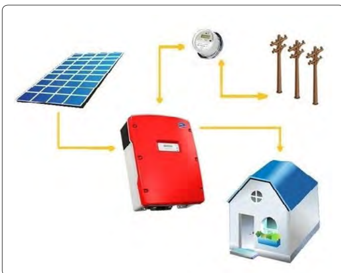
Shema ongrid fotovoltaičnega sistema. Vir: www.kenbrooksolar.com
