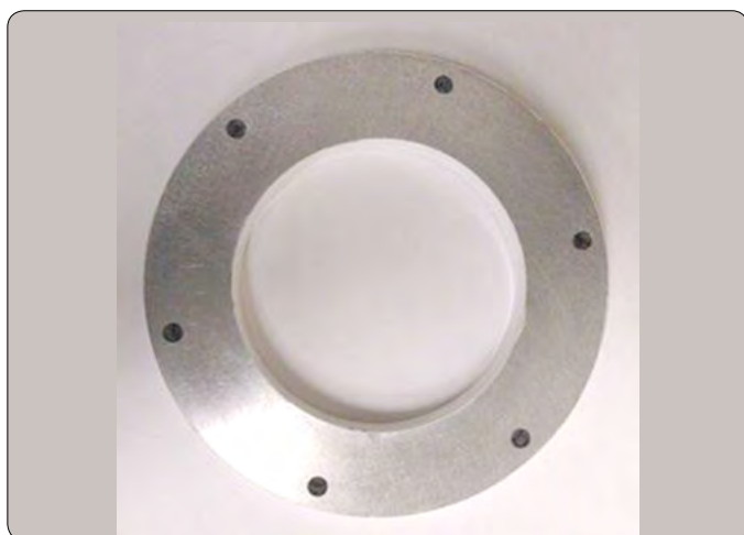
Slika 4: Pri preskusih z Mini Box je obroč s premerom 100 mm držal in stiskal preskusni vzorec na mestu.
