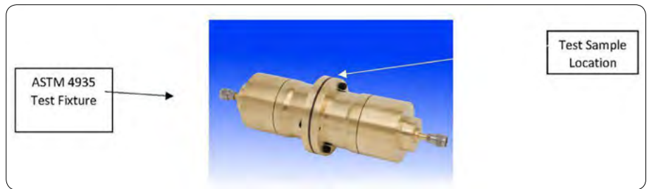
Slika 5: Koaksialna pritrditev, ki prikazuje lokacijo vzorca za ASTM D4935 teste
