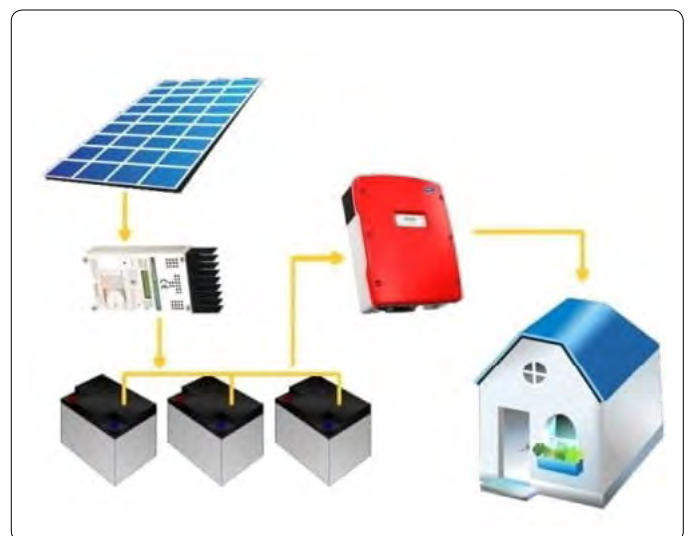
Shema offgrid fotovoltaičnega sistema. Vir: www.kenbrooksolar.com
