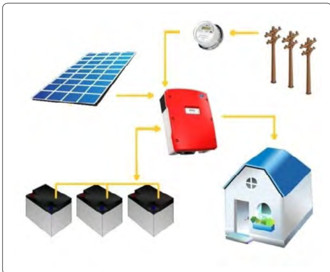
Shema hibridnega fotovoltaičnega sistema. Vir: www.kenbrooksolar.com
