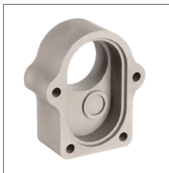
Na sliki od desne proti levi: Ohišje ležaja (MBJ), Kocka iz termoplastičnega poliuretana (SLS), Voščeni pramodel za kalup (DLP), Organska oblika iz PLA (FFF)
