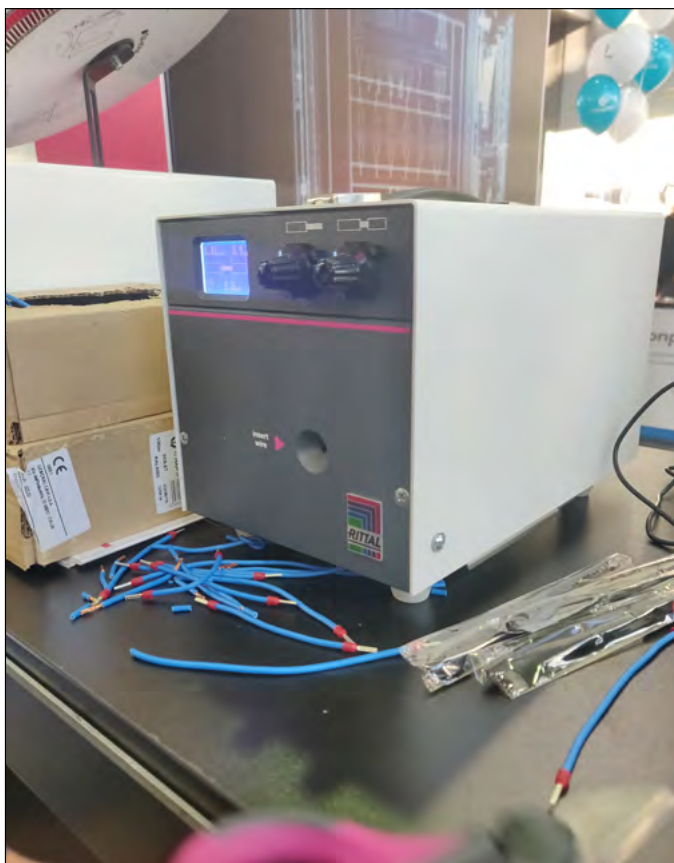
Slika 4: Naprava za snemanje izolacije in natikanje votlice
