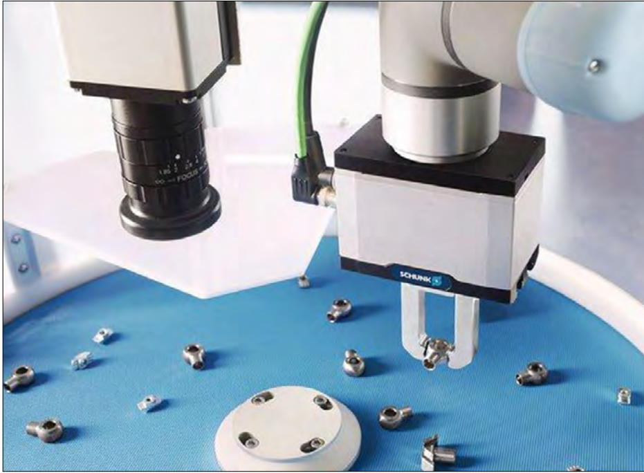
Po kratkem učenju komplet za 2D prijemanje deluje samostojno.
