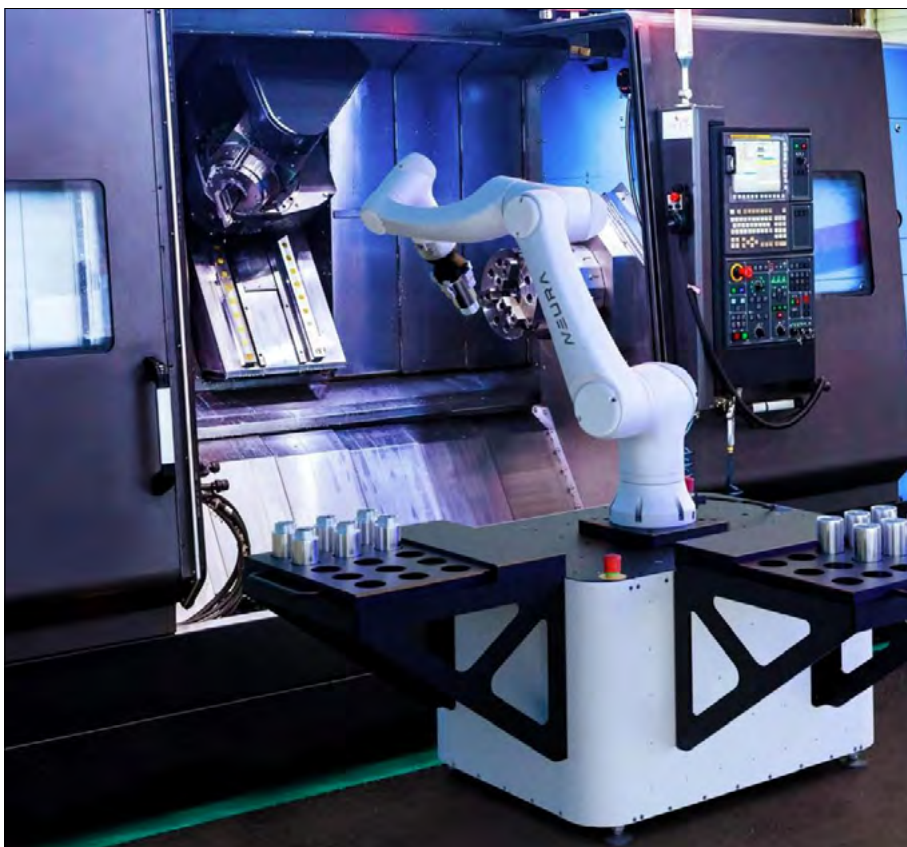
Posluževanje strojev s kolaborativnim robotom LARA – Neura Robotics
