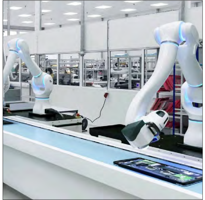
Kontrola kakovosti s kognitivnim robotom MAiRA – Neura Robotics
