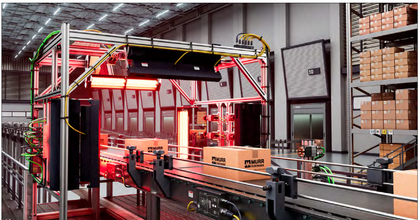
Predor za skeniranje z več bralniki, izdelan v skladu s konceptom „Plug-and-Play“ podjetja Murrelektronik, slika: Murrelektronik GmbH
