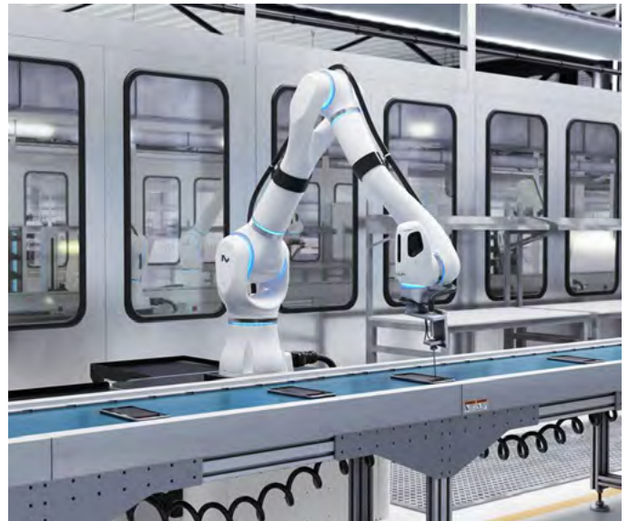
Doziranje s kognitivnim robotom MAiRA - Neura Robotics
