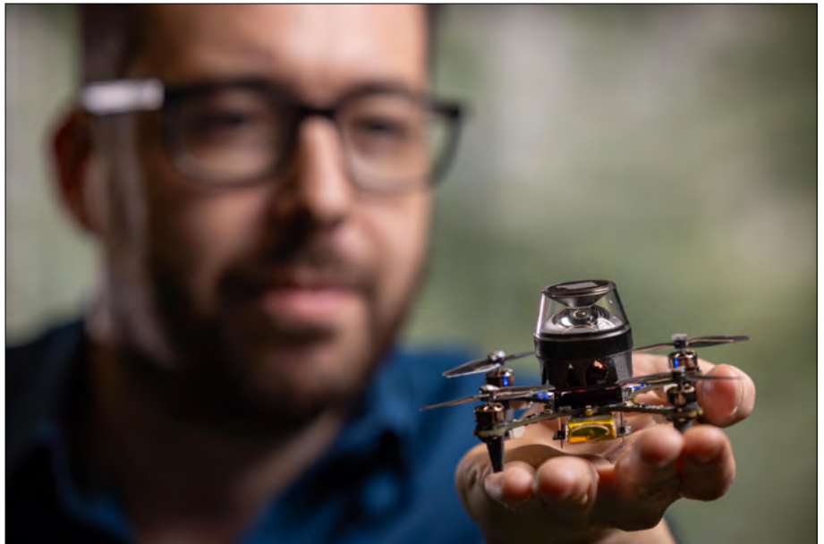
Droben, 56 gramov težak dron „CrazyFlie“, ki se lahko vrne na začetno lokacijo s pomočjo navigacijske strategije, ki so jo navdihnile žuželke (vir: www.tudelft.nl )
