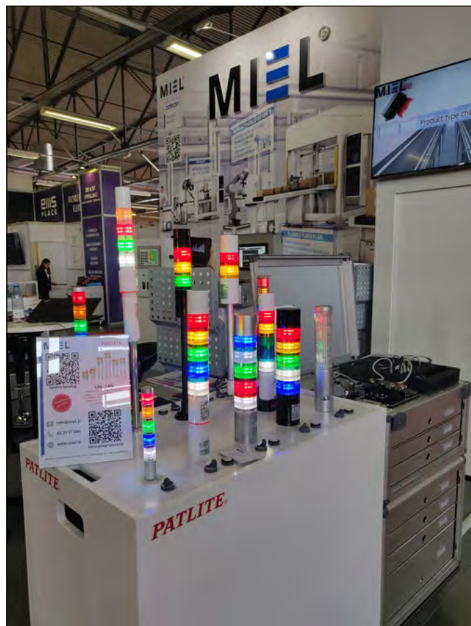
Slika 15: Signalni stolpiči se povežejo preko LAN povezave na krmilnik
