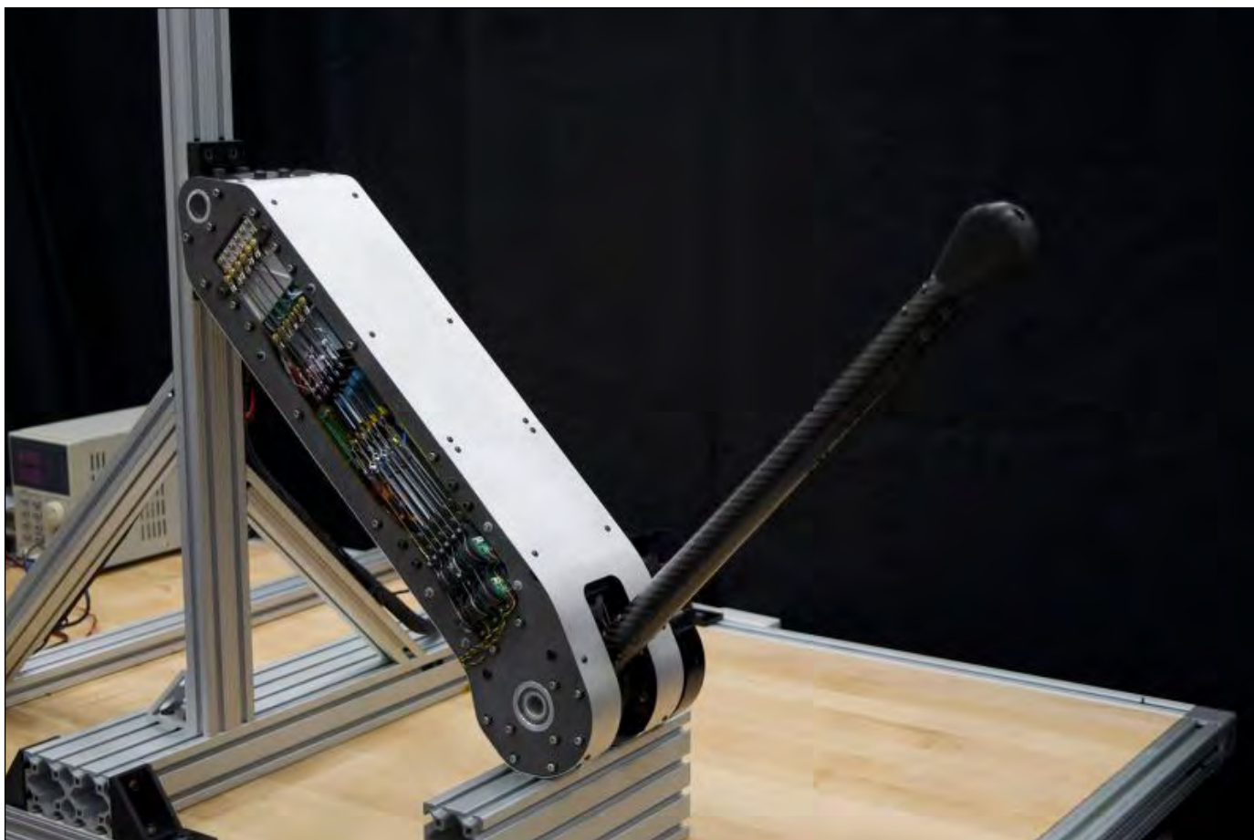
Prototip aktuatorja, ki vrača energijo, vir: Erez Krimsky
