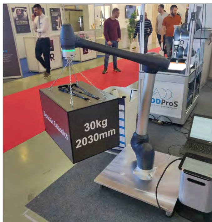
Slika 8: Robotska roka zmore prenesti 30 kg.
