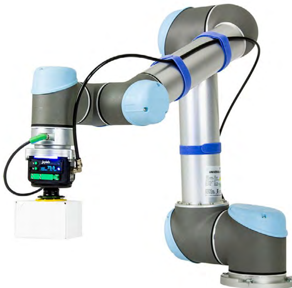
Kobot opremljen s Piabovo vakuumsko ejektorsko enoto na stisnjen zrak piCOBOT®
