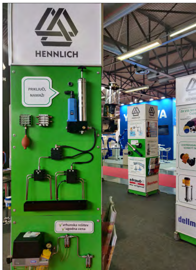
Slika 3: Centralni sistem za avtomatsko mazanje
