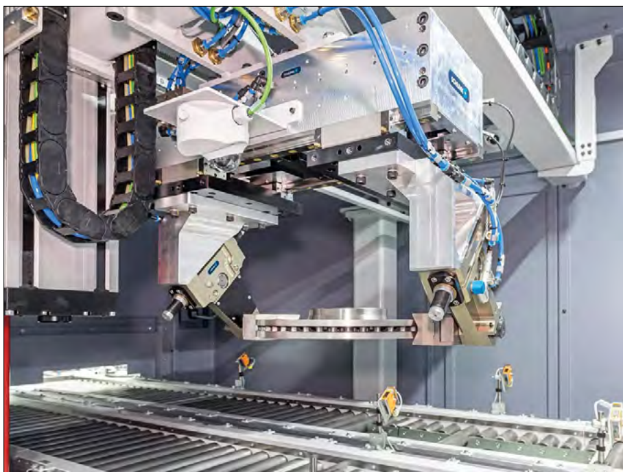
Posamično prilagodljivo standardno prijemalo PLG je popolna rešitev za rokovanje velikih in težkih komponent. V podjetju EMAG se pnevmatično prijemalo z dolgim hodom uporablja za strego zavornih diskov v sistemu za nanos prevleke.
