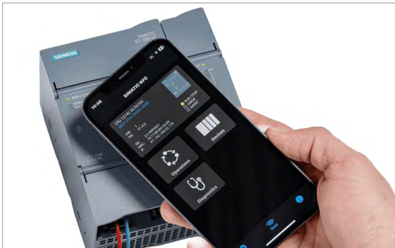
Slika 5: NFC za dostop do diagnostike in podatkov naprave
