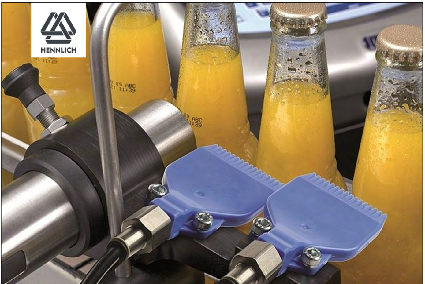
Slika 1: Šobe Lechler Whisperblast® odstranjujejo neželene kapljice, da se lahko kasneje označevanje izvede brez težav.
