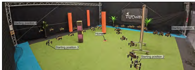
Slika 3: Robotski poskus v Cyberzoo na Tehniški univerzi v Delftu. Po učnem poletu je robot sposoben vrniti se z različnih lokacij znotraj naučenega območja na izhodiščno lokacijo. Robot ne potrebuje vidnega stika z izhodiščem, saj učenje temelji na odometriji.
