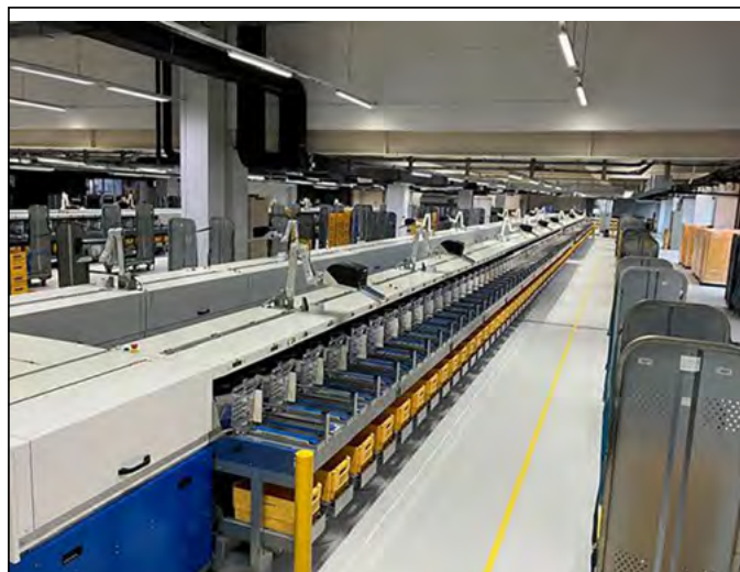
Stroji za razvrščanje ravnih in pisemskih pošilk TT-2000 so zdaj v polnem pogonu (vir: Toshiba)
