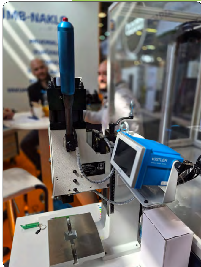
Slika 8 Ročna stiskalnica s pnevmatskim 5 mm hodom
